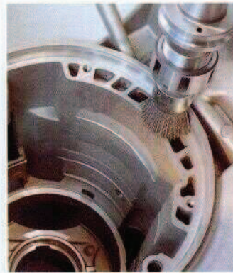
Stirnflächen-Entgraten an einem Getriebegehäuse mit einer Alpha Pinselbürste.
