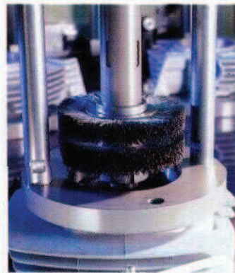
Zwei Alpha Einzelscheiben-Bürsten honen einen Zylinderkopf.
