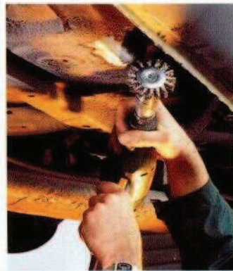
Entfernen von Unterbodenschutz mit einer Ultra Schafrundbürste.
